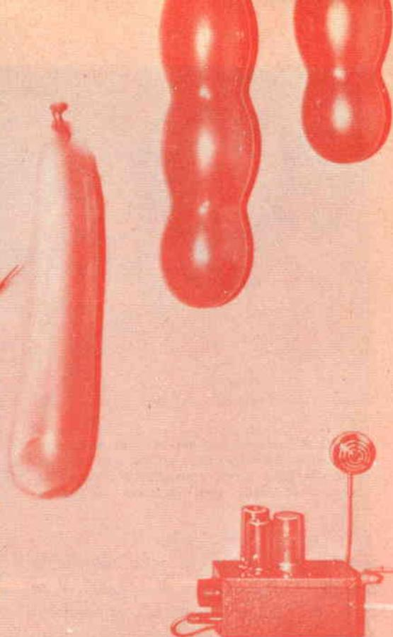
**Con un flash e questa unità elettronica di comando potete usare i suoni per fermare le immagini di un corpo in movimento**
