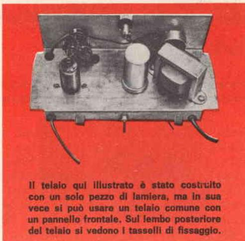
Il telaio qui illustrato è stato costruito con un solo pezzo di lamiera, ma in sua vece si può usare un telaio comune con un pannello frontale. Sul lembo posteriore del telaio si vedono i tasselli di fissaggio.
