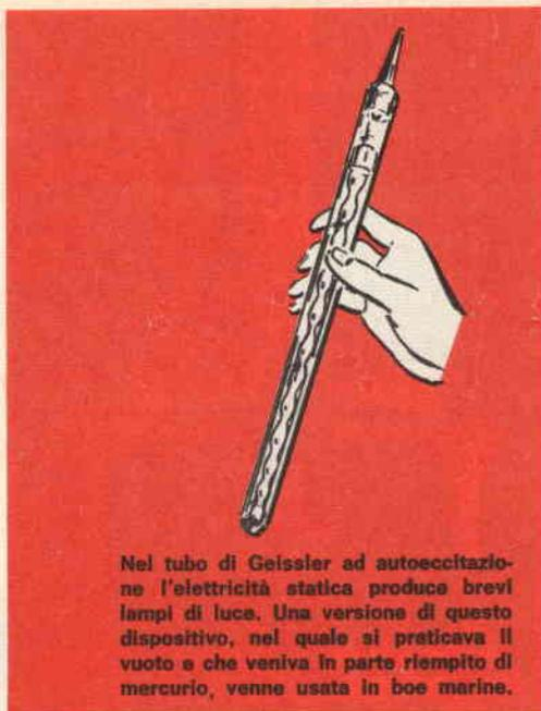
Nel tubo di Geissler ad autoeccitazione l'elettricità statica produce brevi lampi di luce. Una versione di questo dispositivo, nel quale si praticava il vuoto e che veniva in parte riempito di mercurio, venne usata in boe marine.
